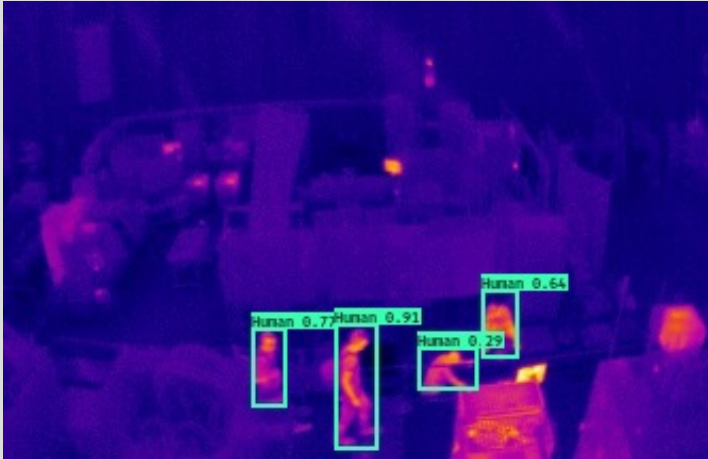
Abbildung 1: Detektion der Positionen von Personen in der ETA-Fabrik auf Basis von Wärmebildkameraaufnahmen
