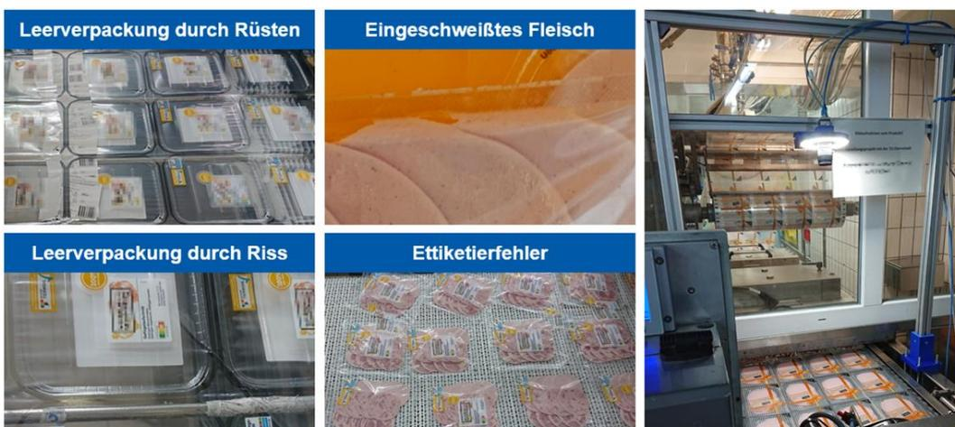
Abb. 1.: Aufbau der optischen Einheit zur Erfassung fehlerhafter Verpackungen mittels Methoden des Deep Learning
